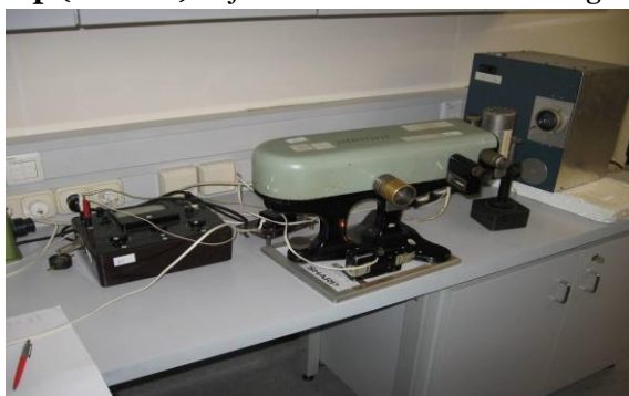
1. ábra: a mérésben használt TB-2 spektroszkóp /az ábra forrása [2*]/
